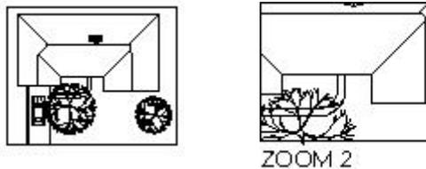
Wenn Sie nach dem Wert **X** eingeben, bestimmt AutoCAD LT den Faktor relativ zur aktuellen Ansicht. Wenn Sie beispielsweise **0.5x** eingeben, werden alle Objekte auf dem Bildschirm mit der Hälfte der aktuellen Größe dargestellt.
